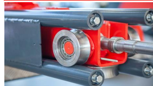
Płynna praca dzięki wózkom z łożyskami tocznymi
